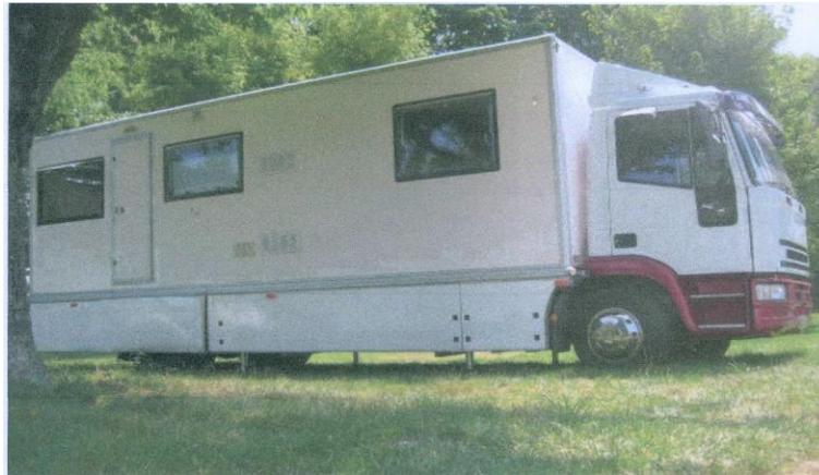
Vehículo usado para el transporte de mercancías, transformado permanentemente en un minibús acondicionado para el alojamiento de personas mediante el montaje en el chasis de una nueva carrocería que tiene una sola puerta de acceso y está equipado con dormitorio con cama doble, cocina provista de electrodomésticos, ducha, sanitarios, sofá de tres plazas, mesa, armario, etc.
