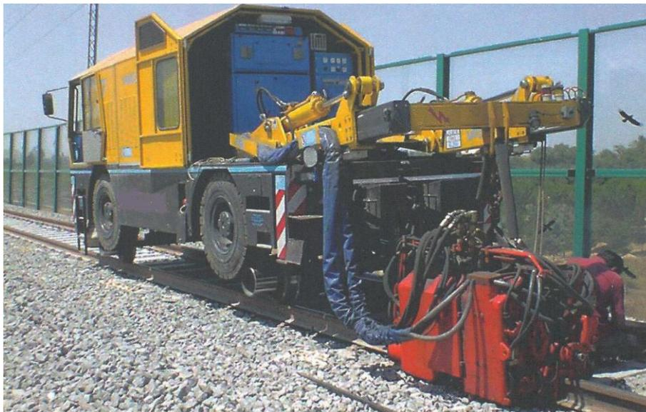
Vehículo automóvil ensamblado sobre un chasis, compuesto de carriles longitudinales y cuatro refuerzos transversales tubulares, de acero. El vehículo dispone de una cabina de conducción con dispositivos de control, un cabezal soldador sujeto a una pluma doble montada en una torreta giratoria para realizar labores de soldadura eléctrica, y un generador. El vehículo puede circular por vías férreas así como por carretera.
