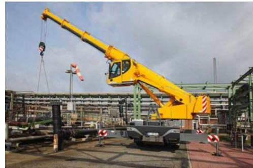
Esta grúa tiene una cabina de conducción para el operario, en la que se encuentran los mandos tanto para el manejo de la grúa como para su conducción.
