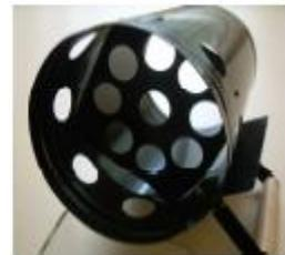
Encendedor de carbón en forma de tambor de acero con aperturas en ambos extremos provistos de una manija y con una plancha de metal perforado que crea dos cámaras en su interior. El diseño del artículo hace que se cree un efecto chimenea que acelera la combustión del carbón hasta que este se encuentre listo para ser esparcido sobre la barbacoa o parrilla.
