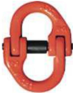
Constituido por dos elementos simétricos en arco de círculo que quedan unidos por medio de un pasador de acero y de un anillo de retención que mantiene el conjunto. Está destinado a integrarse en los mecanismos de elevación (extremidades de aparejos de suspensión textil, ganchos, cabezas de malla, etc.).
